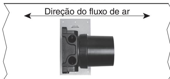
**IMPORTANTE:** A PLACA DE MONTAGEM DEVE SER ORIENTADA CONFORME APRESENTADO. ASSIM QUE A PLACA DE MONTAGEM ESTIVER FIXA À PAREDE DA CONDUTA, A CAIXA DE LIGAÇÕES DE SAÍDA PODE SER RODADA PARA QUALQUER POSIÇÃO CONVENIENTE.
