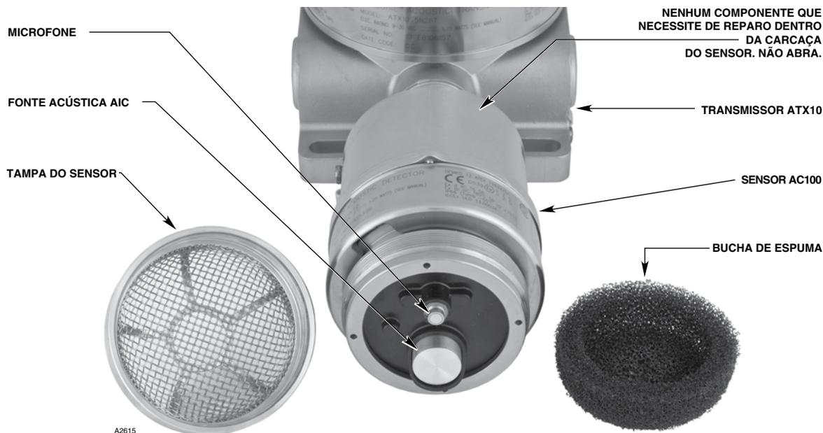
Figura 18—Detector acústico com a tampa do sensor de proteção removida
