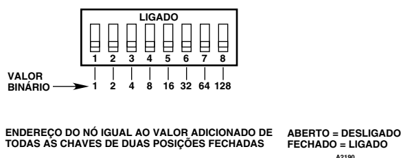
Figura C-1 — Chaves de endereço do OPECL
