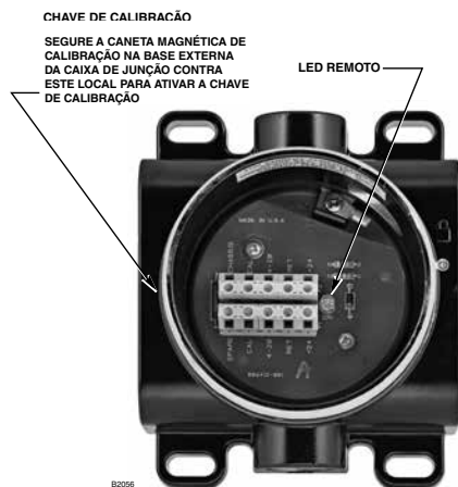
Figura 17 — Chave de Calibração Remota e LED Opcional Caixa de Terminação PIRTB da Det-Tronics
