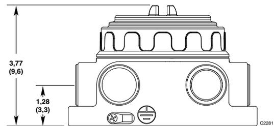
Figura 5 — Dimensões do PIRTB em polegadas (cm)
