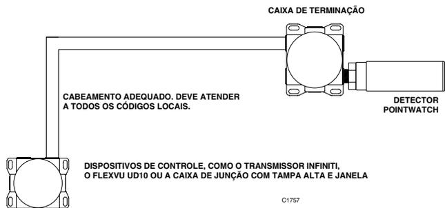
Figura 21 — Opção para separação do detector
