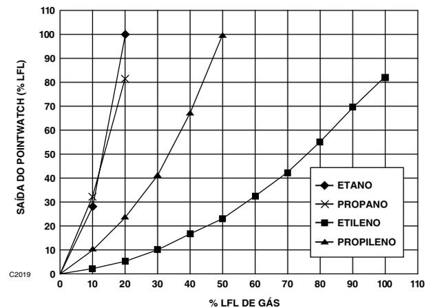
Figura 8 — Resposta do PIR9400 (configuração de fábrica) calibrado para metano para outros gases, em temp. amb. = 25 °C
