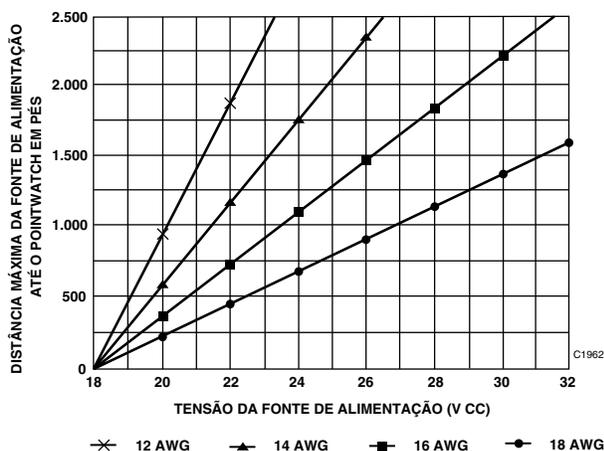
Figura 2 — Exigências de Cabeamento do PIR9400
