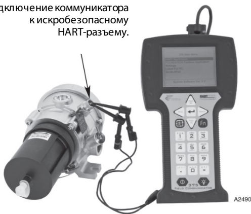
Рис. 19. HART-коммуникатор (модель 475), подсоединенный к HART-разъему газоанализатора.
