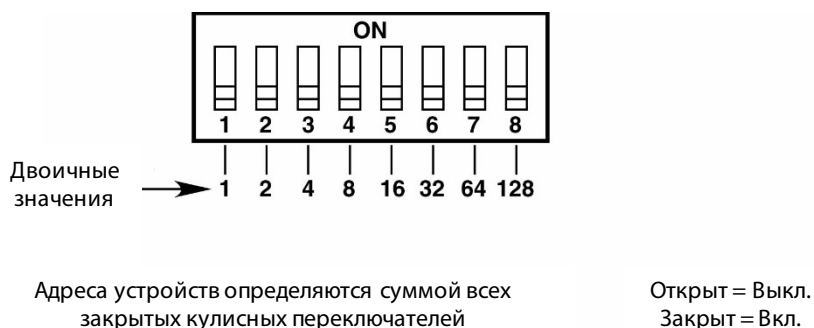
Рис. D-1. Адресные переключатели газоанализатора PIRECL-FR
