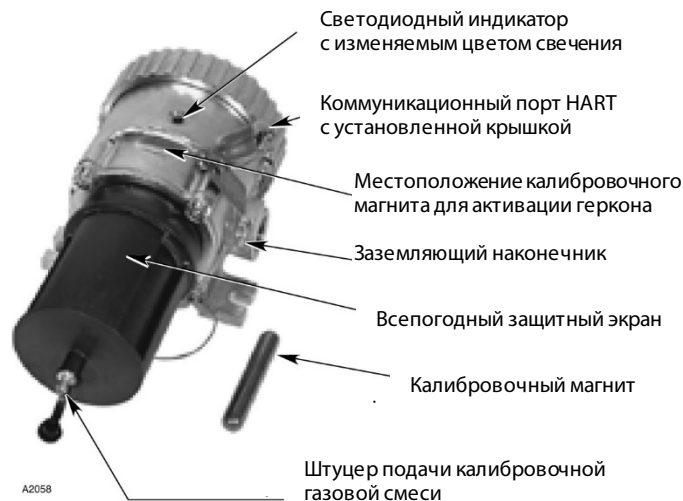
Рис. 18. Газоанализатор PIRECL-FR, общий вид.
