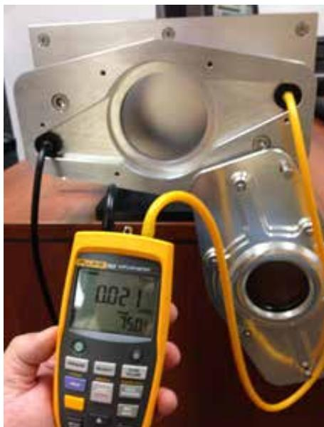
Рисунок 12. Пример измерительного манометра (Набор Q5016 не установлен)
