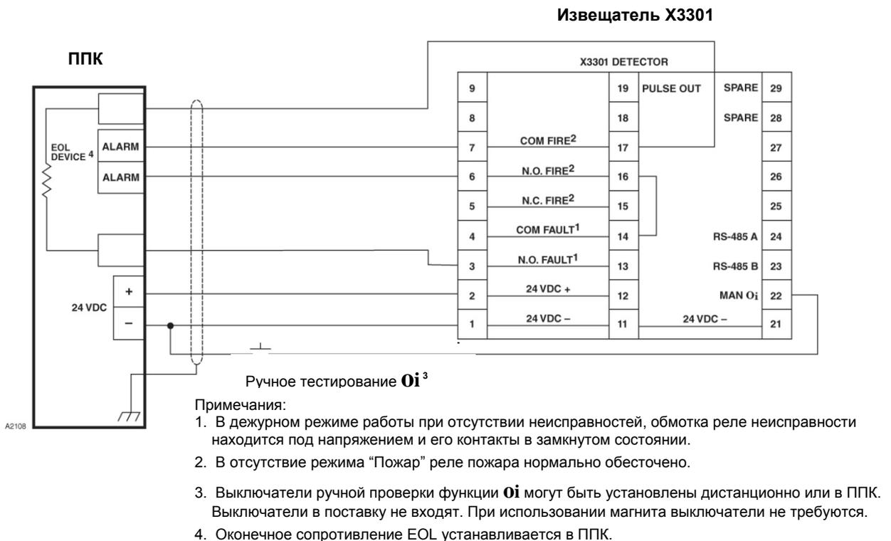
Рис. 13. Пример схемы подключения извещателя во взрывозащищённом исполнении повышенной надёжности Exde.
