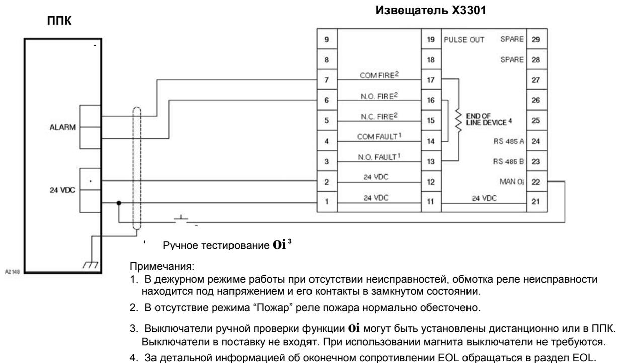
Рис. 12. Пример схемы подключения извещателя во взрывозащищённом исполнении Exd.
