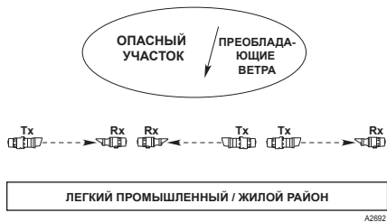
Рис. 6 — Правильный порядок расположения модулей при установке нескольких систем
