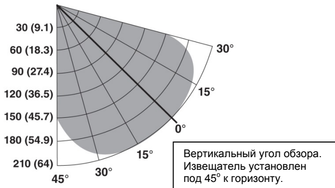
Угол обзора для этанола (0,3 x 0,3 м) при очень высокой чувствительности
