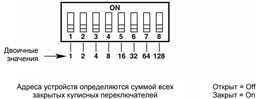
Рис. 18. Адресные переключатели извещателя X3301.
