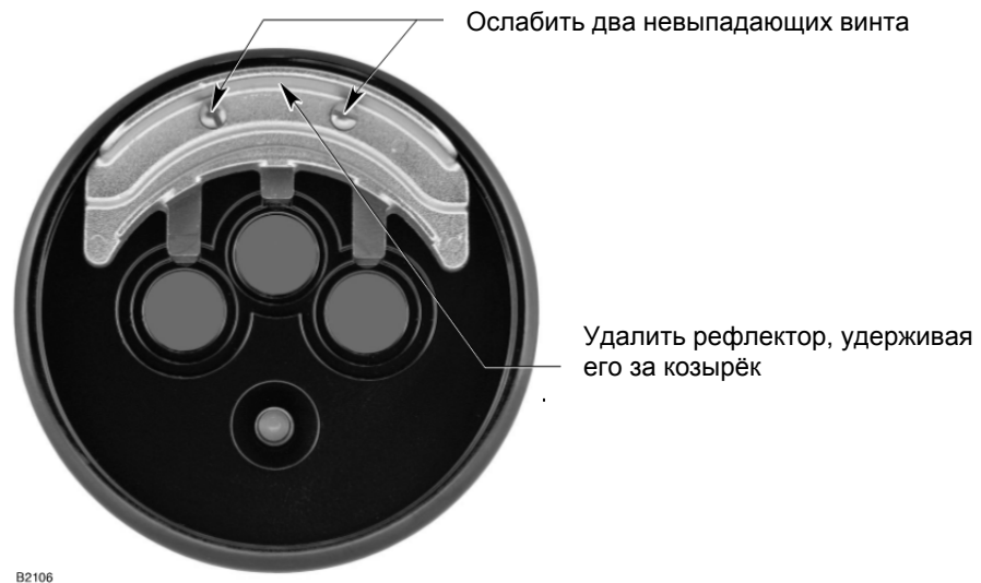
Рис. 19. Снятие рефлектора Oi
