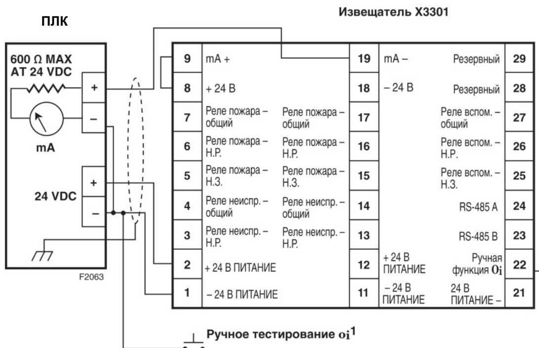
Рис. 10. Схема подключения извещателя с неизолированным выходом 0-20 мА (извещатель в качестве источника тока).
