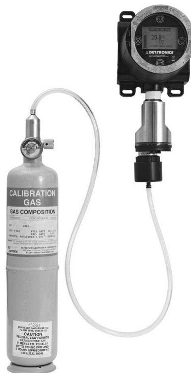
Рис. 1. Подсоединение калибровочного набора к газоанализатору GT3000.
