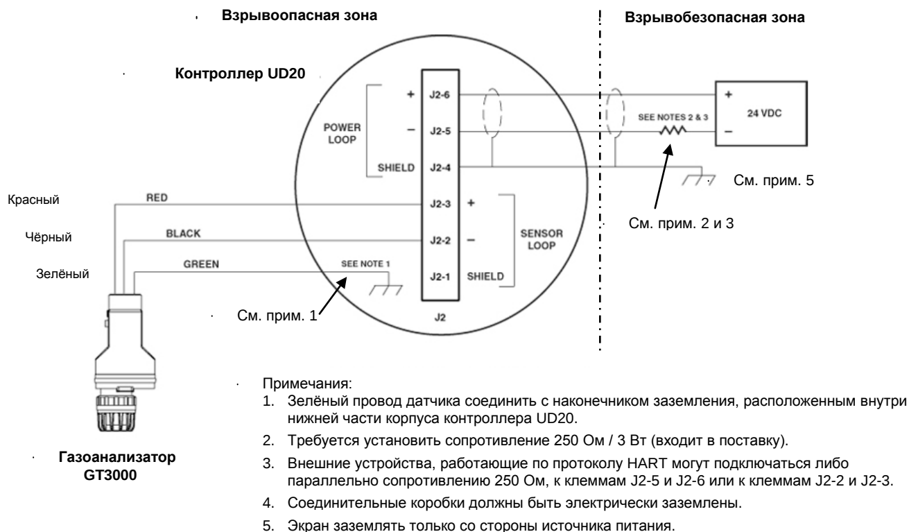
Рис. 5. Газоанализатор, подключенный непосредственно к контроллеру во взрывоопасной зоне.
