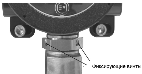
Рис. 6. Месторасположение элементов фиксации (только для моделей с метрической резьбой).
