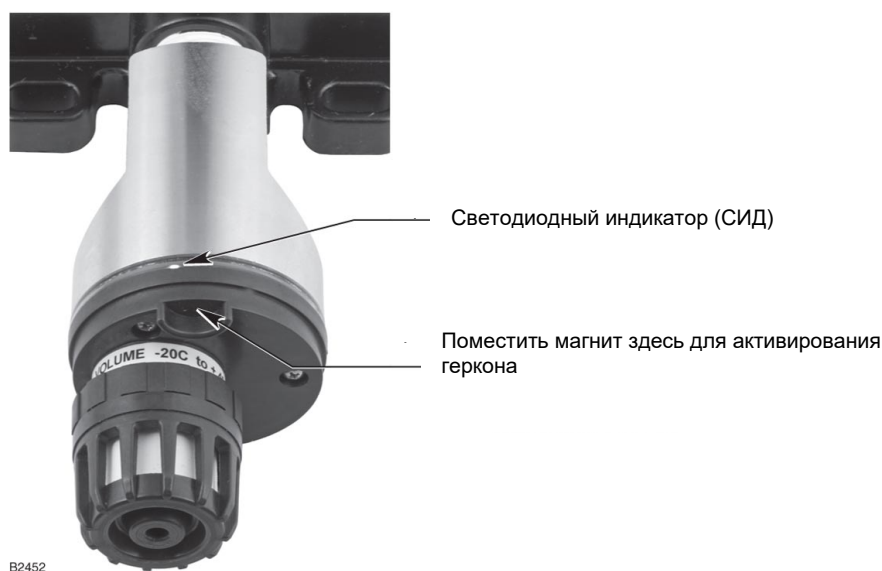
Рис. 14. Местоположение геркона.
