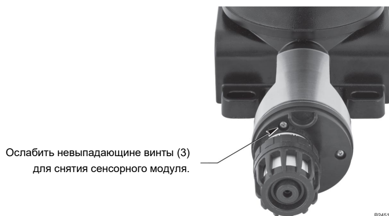
Рис. 16. Месторасположение винтов для смены сенсорного модуля.
