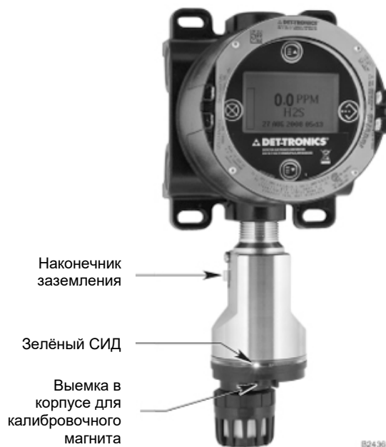
Рис. 5. Правильная ориентация при установке газоанализатора GT3000.
