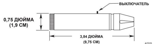
Рисунок 3. Размеры лазерного позиционера
