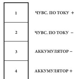
Рисунок 3-18-J2: Точки измерения параметров АКБ
