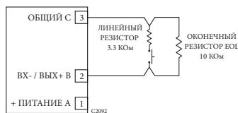
Рисунок 3-25 - Конфигурация контролируемого входа для обнаружения обрывов и замыканий - класс В
