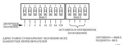
Рисунок 3-56-Переключатели адресов периферийных устройств для ARM, SAM, DCU и IDC
