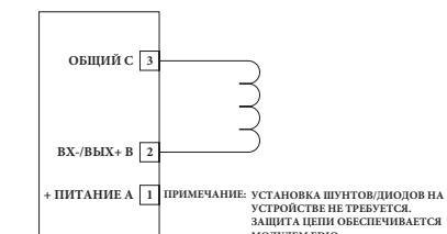
Рисунок 3-40 - Конфигурация контролируемого выхода (автоматический выпуск)
