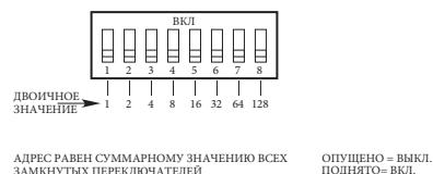
Рисунок 3-57 - Переключатель адресов для AIM, EDIO, DCIO и релейного модуля
