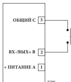
Рисунок 3-36 Конфигурация неконтролируемого входа
