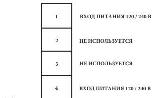
Рисунок 3-16-J3: Клемма подключения питания переменного тока
