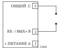
Рисунок 3-22 Конфигурация неконтролируемого входа
