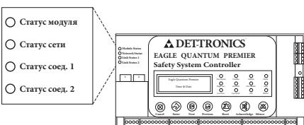
Рисунок 4-5 -Расположение светодиодных индикаторов состояния Ethernet DLR
