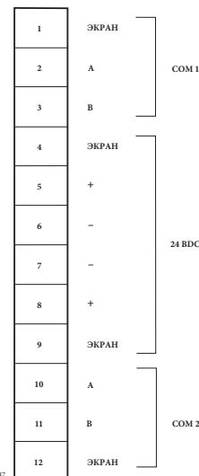
Рисунок 3-3 - Обозначение клемм сетевого подключения расширителя
