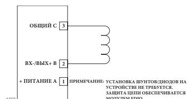
Рисунок 3-41 Конфигурация неконтролируемого выхода
