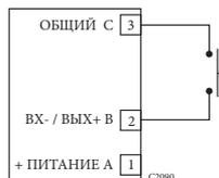
Рисунок 3-22 Конфигурация неконтролируемого входа
