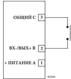
Рисунок 3-36 Конфигурация неконтролируемого входа
