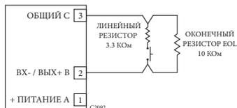
Рисунок 3-25 - Конфигурация контролируемого входа для обнаружения обрывов и замыканий - класс В
