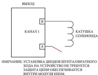
Рисунок 3-53В - Конфигурация контролируемого выхода с соленоидным расцепителем - класс В
