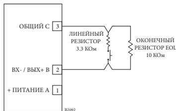
Рисунок 3-38 - Конфигурация контролируемого входа (обрыв и короткое замыкание)
