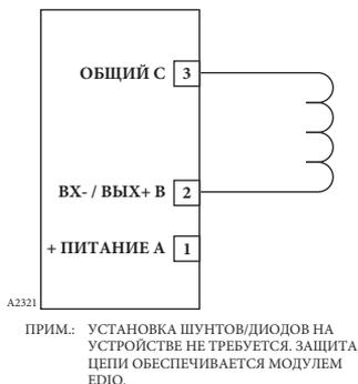
Рисунок 3-29—Конфигурация неконтролируемого выхода
