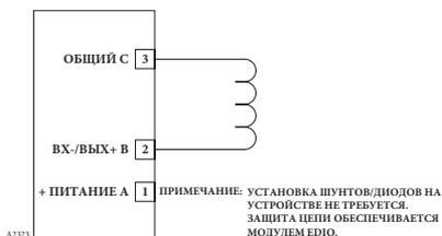
Рисунок 3-40 - Конфигурация контролируемого выхода (автоматический выпуск)
