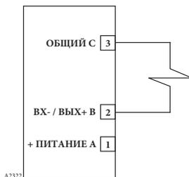
ПРИМЕЧАНИЕ: УСТАНОВКА ШУНТОВ/ДИОДОВ НА УСТРОЙСТВЕ НЕ ТРЕБУЕТСЯ. ЗАЩИТА ЦЕПИ ОБЕСПЕЧИВАЕТСЯ МОДУЛЕМ EDIO.
