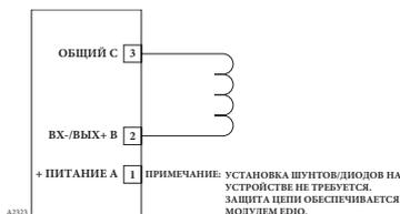
Рисунок 3-41 Конфигурация неконтролируемого выхода
