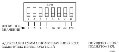
Рисунок 3-57 - Переключатель адресов для AIM, EDIO, DCIO и релейного модуля
