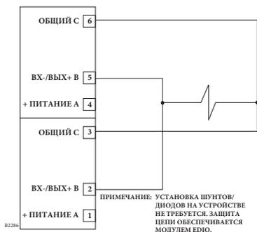
Рисунок 3-33 - Конфигурация контролируемого выхода (Выпуск реагента) - подключение класса А
