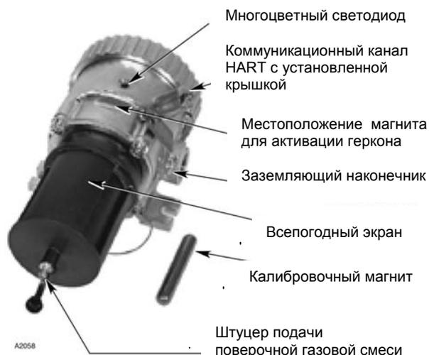
Рис. 19. Газоанализатор PIRECL, общий вид.
