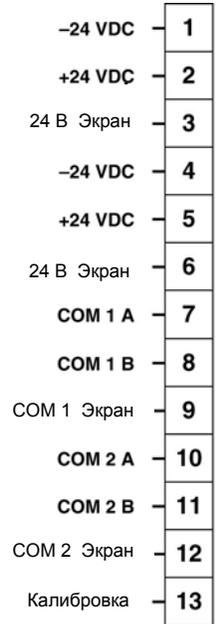
Рис. 14. Клеммы соединения модели PIRECL EQP.
