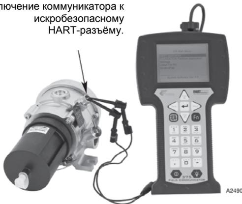
Рис. 20. HART-коммуникатор, подсоединенный к HART-разъёму газоанализатора.
