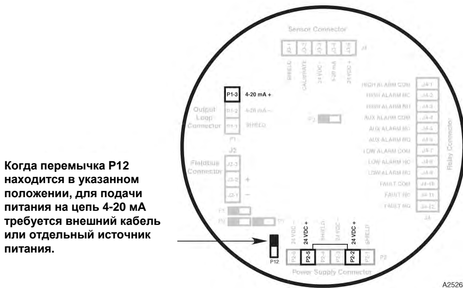
Рис. 7. Положение перемычки P12 при использовании выходной цепи сигнала 4-20 мА в схеме с изолированным выходом.
