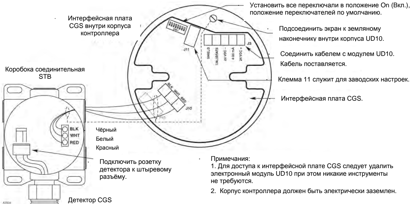
Схема подключения детектора CGS с соединительной коробкой STB к контроллеру UD10.
