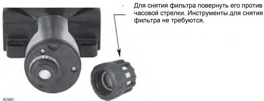
Рис. 15. Газоанализатор GT3000 со снятым сменным фильтром.
