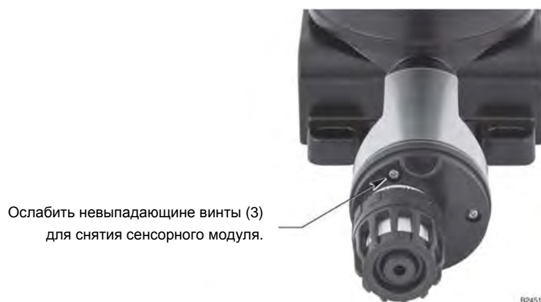
Рис. 16. Месторасположение винтов для смены сенсорного модуля.
