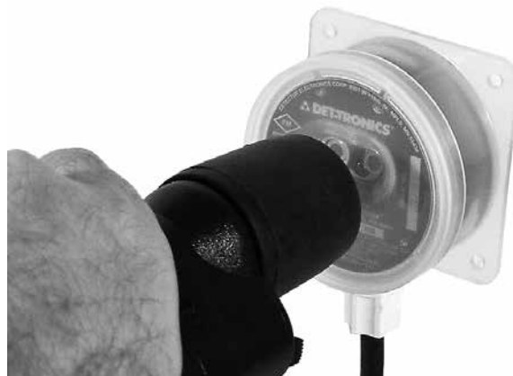
Figure 3 – Test d'un PM-5MPX avec une Lampe-Test PSS-MP
