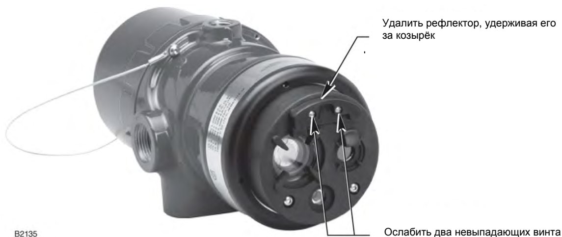
Рис. 19. Снятие рефлектора oi .
