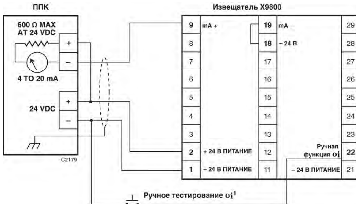
Рис. 12. Схема подключения извещателя с неизолированным выходом 0-20 мА (извещатель в качестве потребителя тока).
