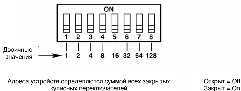
Рис. 18. Установка адресов извещателя X9800
