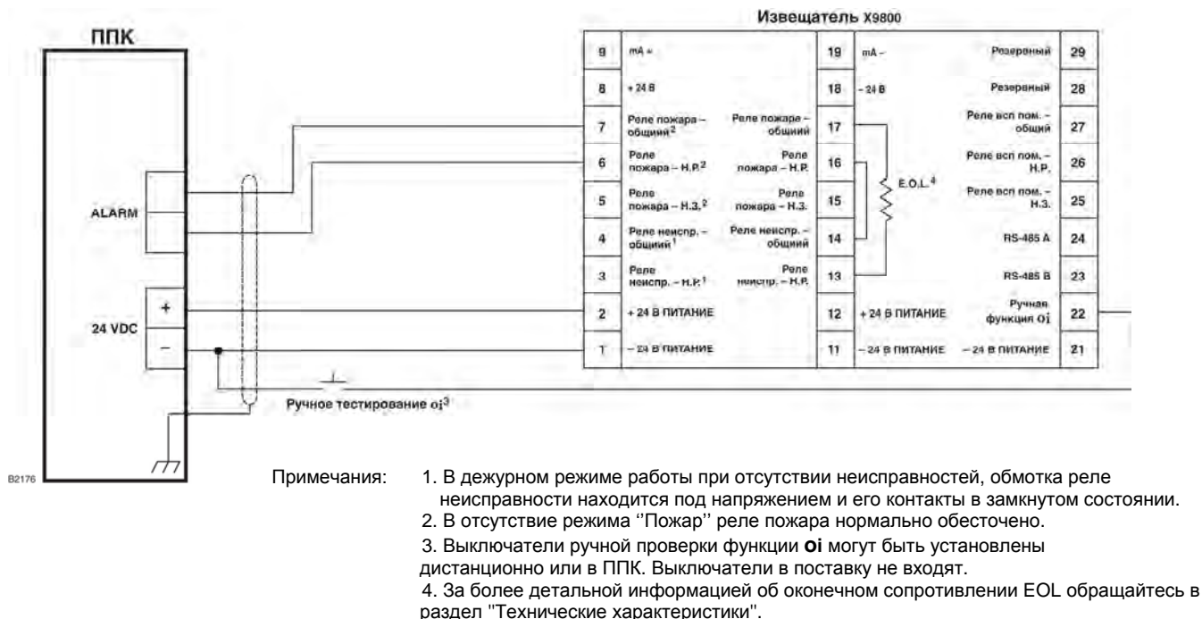
Рис. 9. Пример схемы подключения извещателя во взрывозащищённом исполнении Exd.
