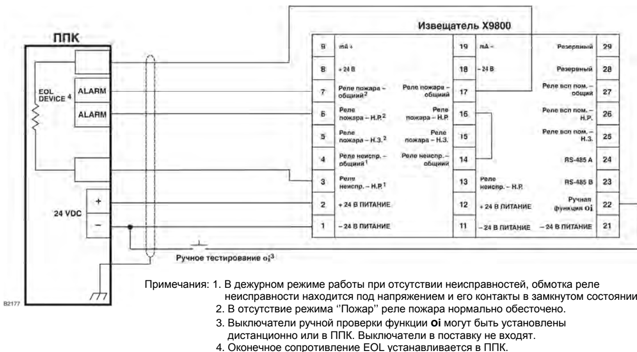
Рис. 10. Пример схемы подключения извещателя во взрывозащищённом исполнении повышенной надёжности Exde.
